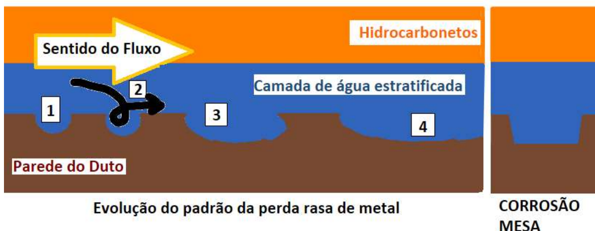
Figura 9 – Morfologia da corrosão sweet . Fonte: Traduzido de Palmer e King (2008)
