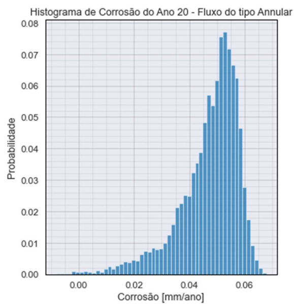
Figura A-5: Histogramas de corrosão dos anos 1, 5, 10 e 20 para o fluxo tipo anular
